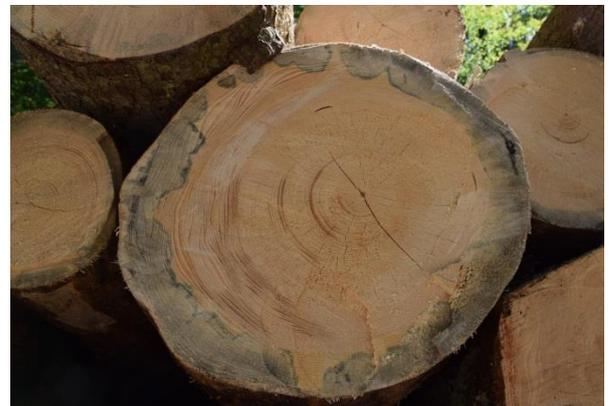
Abbildung 32: Käferholz entwertet mit Bläue.
