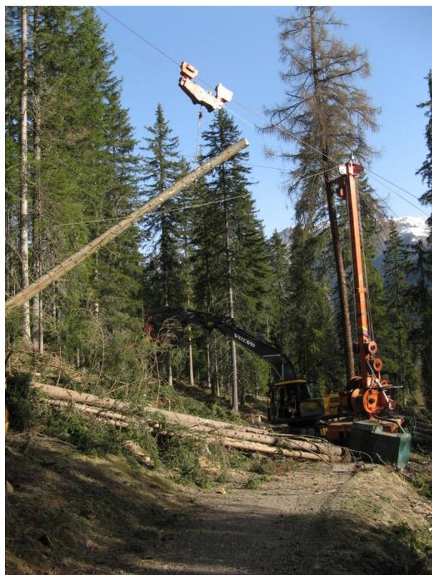
Abb. 6 Mobilseilbahnbetrieb (Foto RFA Bergün-Muot).
